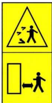
Rys. 2: Zagrożenie obrażeniami spowodowanymi przez latające odłamki, wióry, wyrzucane przedmioty itp. Inne osoby i zwierzęta – zachować bezpieczny odstęp od maszyny.
