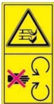
Rys. 4: Nie wolno wkładać rąk ani nóg w przestrzeń roboczą noża koszącego - niebezpieczeństwo przecięcia.
